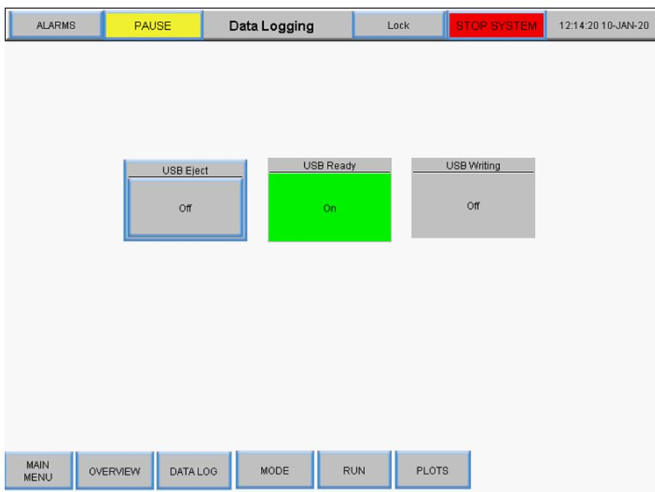
Pour enregistrer les données du procédé, insérer une clé USB dans le port USB du contrôleur. L'enregistrement des données s'active automatiquement à la détection d'une clé USB.
