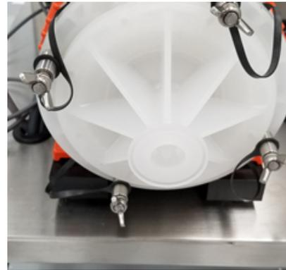
4. Si la pompe est équipée d'une Douille de tête, tournez la bague supérieure dans le sens inverse des aiguilles d'une montre jusqu'à ce que le plongeur s'enclenche et que la Douille de tête de pompe (PHS) soit fermement fermée.
