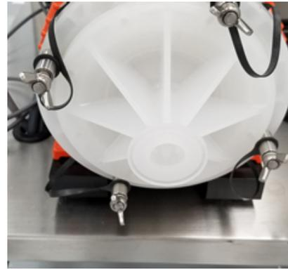
4. In alternativa, se la pompa dispone di un alloggiamento della testa, ruotare l'anello in alto in senso antiorario fino a quando lo stantuffo non scatta in posizione e l'alloggiamento della testa pompante (Pump Head Socket, PHS), non è chiuso bene.
