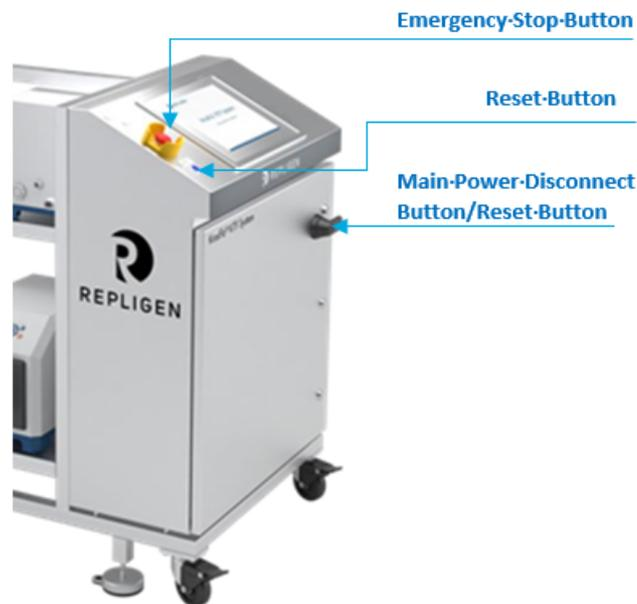
Al presionar el botón de parada de emergencia se pararán todas las bombas, se restablecerán todas las válvulas de control de contrapresión a 0 % cerradas y se enviará una alarma. La secuencia activa del proceso se pone en estado de espera.
